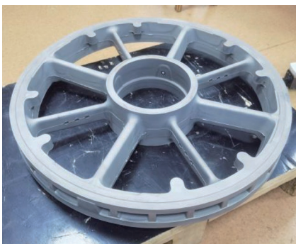
图 11 中国科学院金属研究所研制的 Ti 2 AlNb 粉末冶金构件
